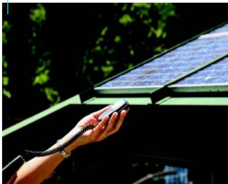
Luxímetro para medir a intensidade da luz.
